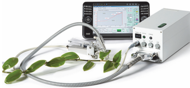
9. ábra: Fluoreszcencia mérésekhez használt PAM-2100 hordozható fluorométer ( http://www.walz.com/downloads/manuals/pam-2500/A_Leaf_Holder_Manual01.pdf )
