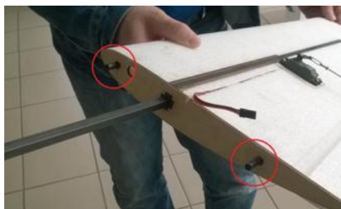
7. ábra A szárnyvégek kapcsolódása a szárnyközéphez
