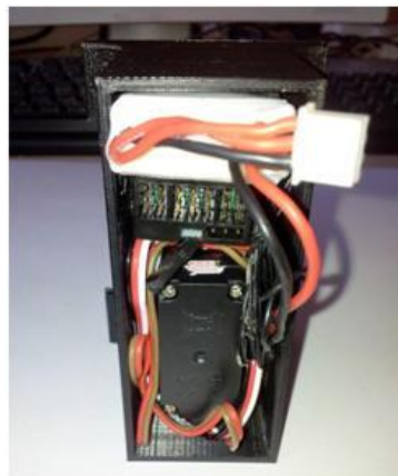
17. ábra A konténerben elhelyezett szervomotor, vevőmodul és akkumulátor
