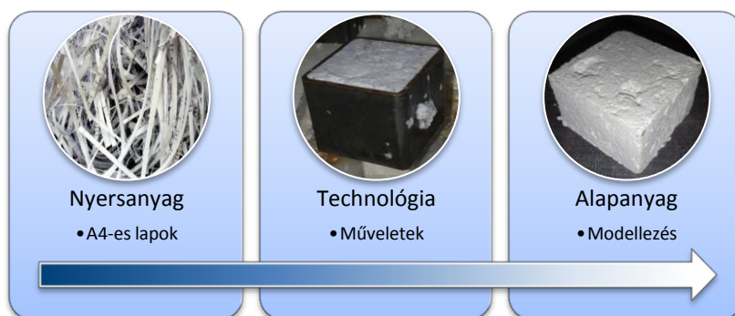
1. ábra. A papír brikett készítésének főbb lépései
