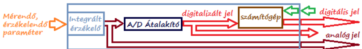
8. ábra Intelligens (SMART) érzékelő
